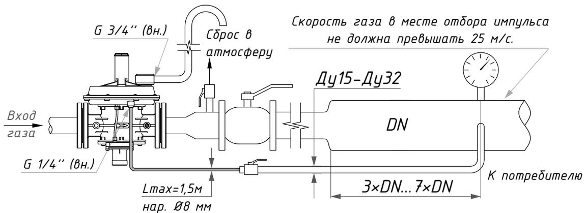
**RG/2MB DN32-DN50 (с угловым переходом)**
