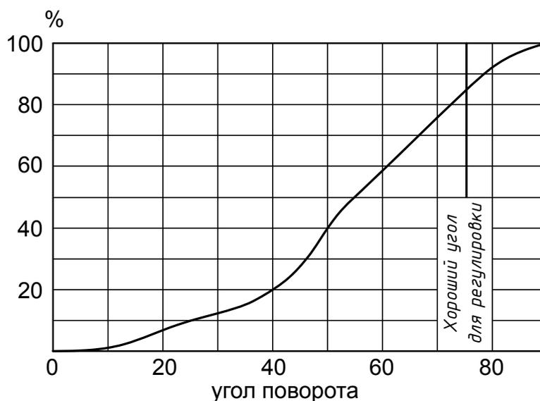
На диаграмме показано, что кривая до 40° имеет зону плавного подъёма. Плавная характеристика облегчает настройку горелки с высоким коэффициентом модуляции, особенно для горелок, работающих на сжиженном газе. НА ЗАМЕТКУ: большие потери давления – более легкая регулировка.
