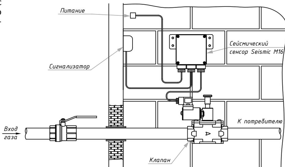
2. Сейсмический сенсор Seismic M16 монтируется на корпус клапана Madas с использованием специального монтажного комплекта.
