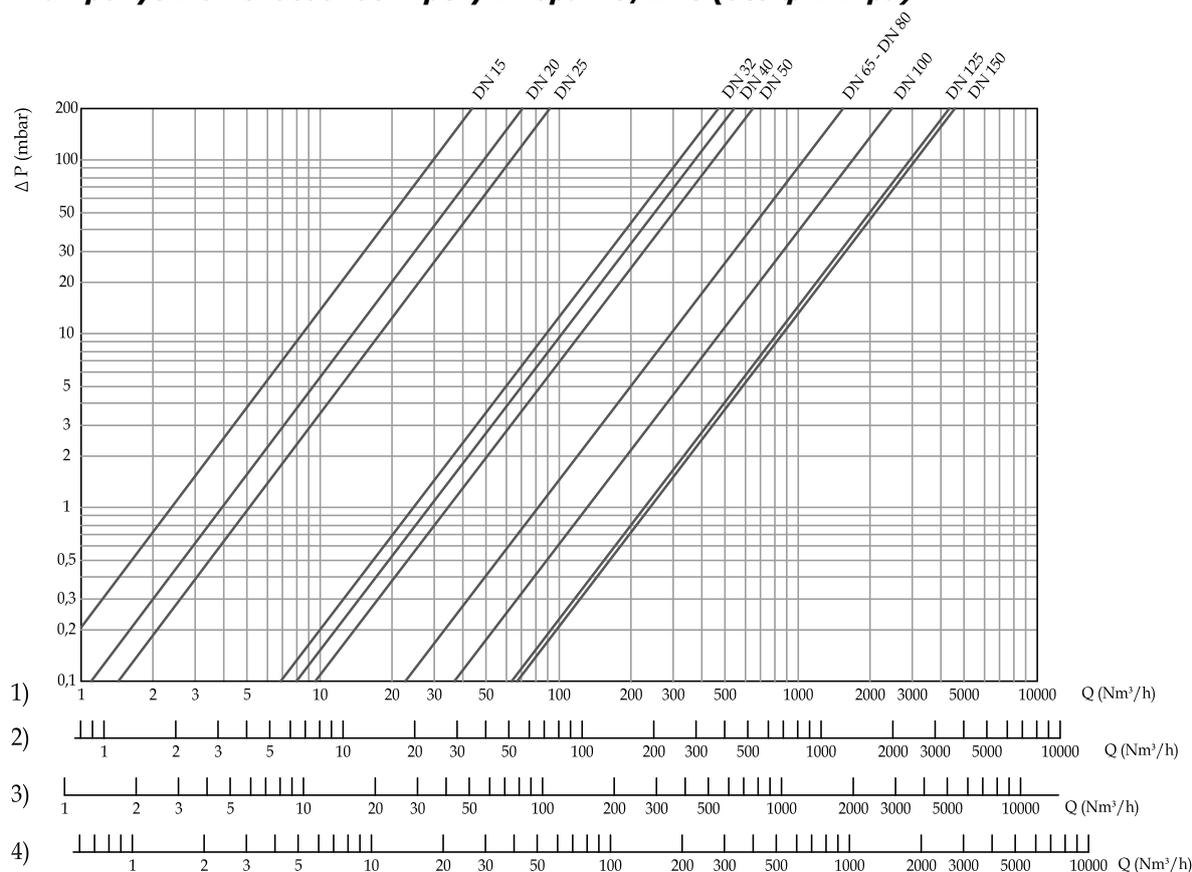
**Диаграмма пропускной способности регулятора FRG/2MC (с фильтром)**
