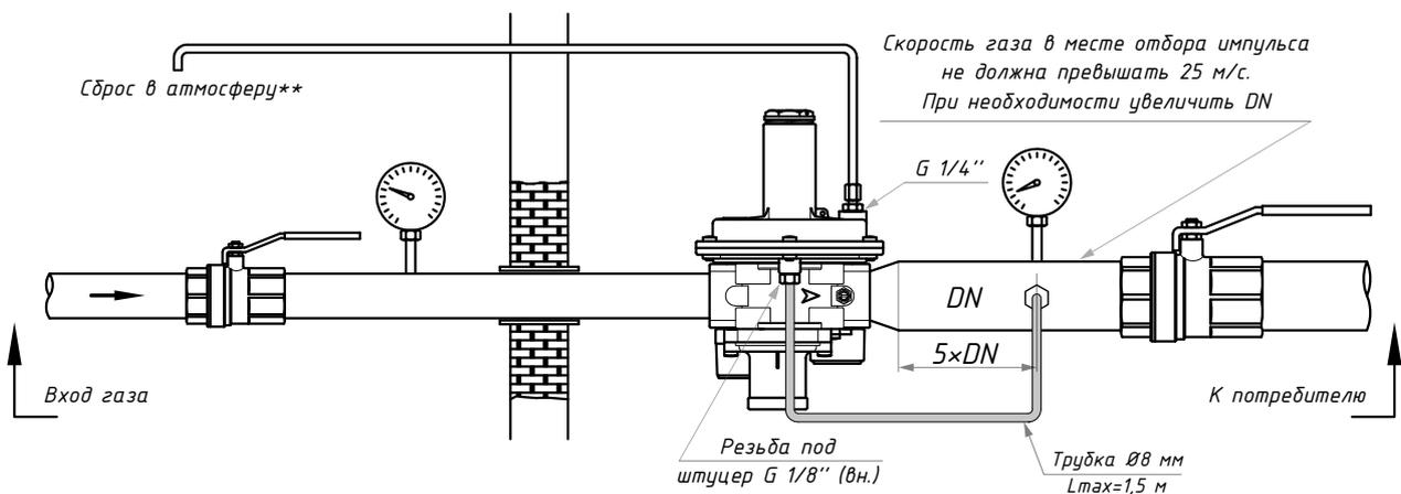
**RG/2MB DN25 «МИНИ» (с внешним импульсом)**
