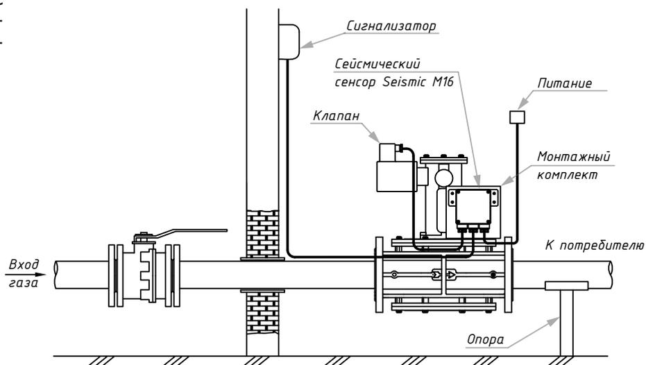
3. Сейсмический сенсор Seismic M16 монтируется на трубу при помощи кронштейна, который приваривается на газопровод. Кронштейн крепится над опорой.
