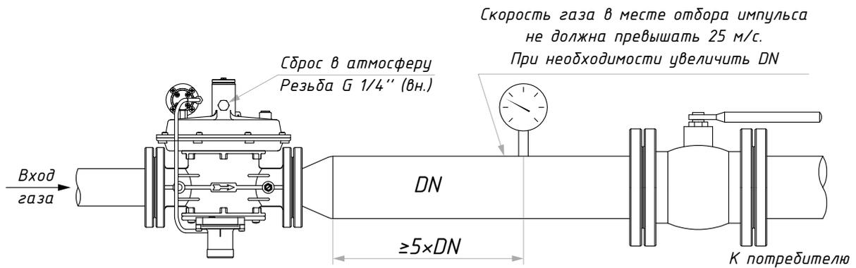
**RG/2MB DN65-DN100 (без расширения)**
