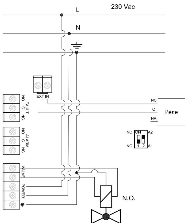
Схема подключения нормально-закрытого электромагнитного клапана
