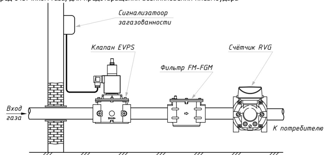
3. В составе блока клапанов контроля герметичности
