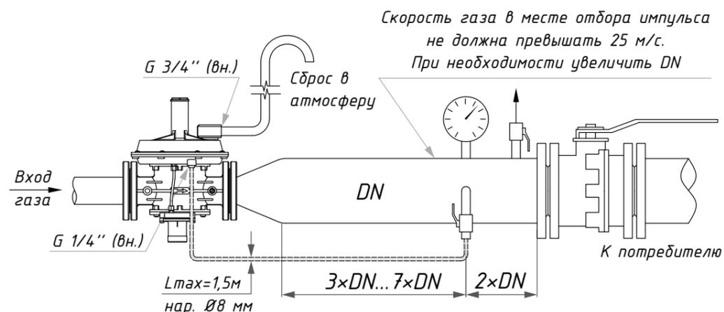
\* - без внешнего импульса разрешено устанавливать регуляторы серии RG/2MB DN32-DN50 при расходе газа не более 200 м³/ч с учетом использования трубы на выходе из регулятора DN50.
