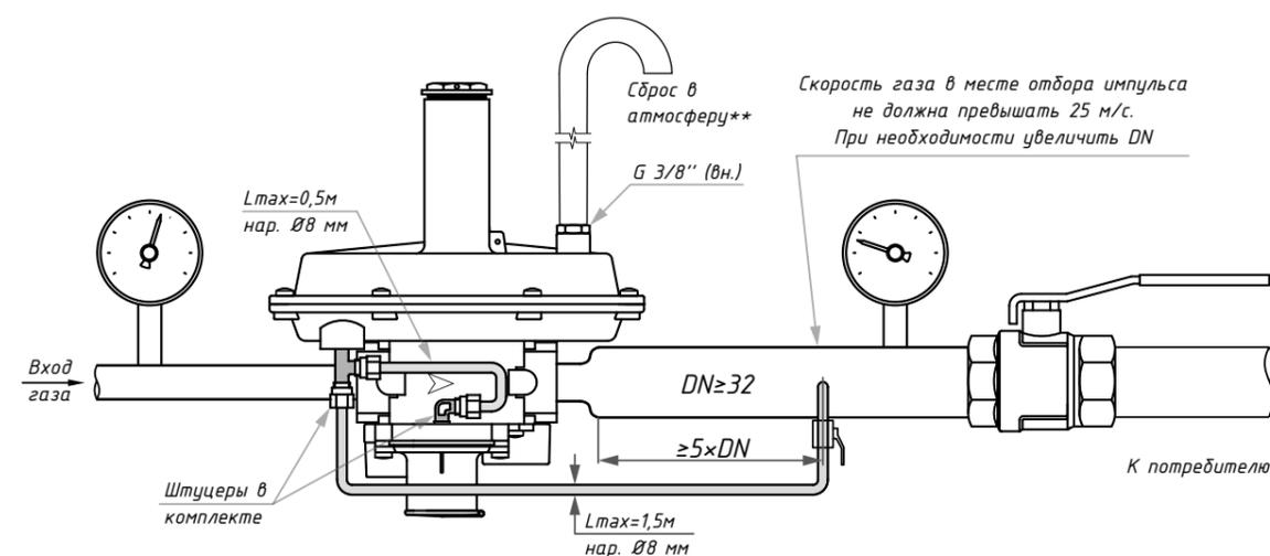
\*\* - при установке регулятора вне помещения, трубу сброса в атмосферу разрешается не монтировать.
