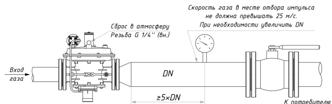
**RG/2MB DN65-DN100 (без расширения)**
