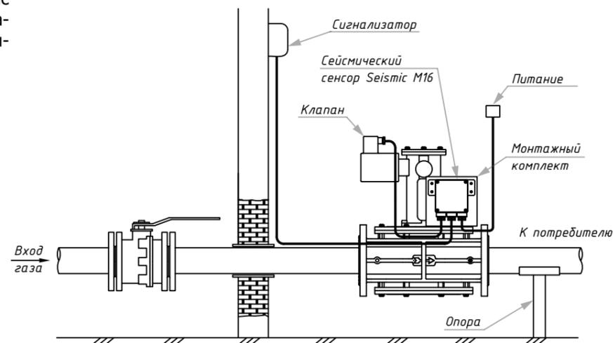
3. Сейсмический сенсор Seismic M16 монтируется на трубу при помощи кронштейна, который приваривается на газопровод. Кронштейн крепится над опорой.
