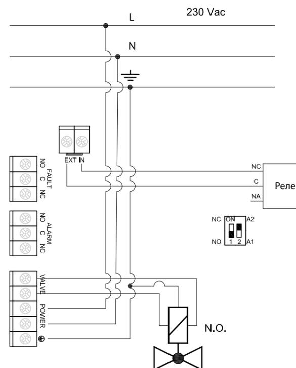
Схема подключения нормально-закрытого электромагнитного клапана
