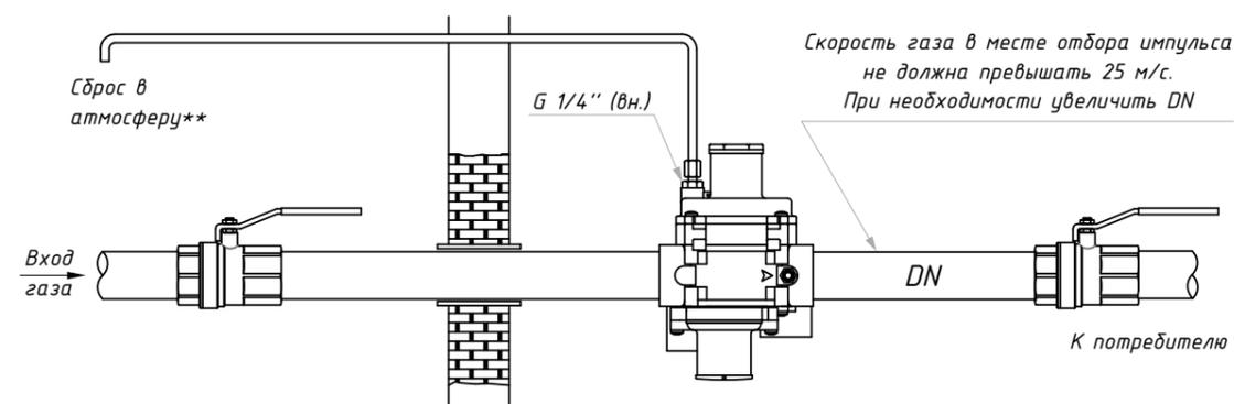
\* - без внешнего импульса разрешено устанавливать регуляторы серии FRG/2MB «Стандарт» DN15-DN25 при расходе газа не более 30 нм³/ч.
