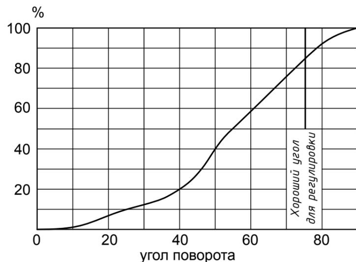
На диаграмме показано, что кривая до 40° имеет зону плавного подъема. Плавная характеристика облегчает настройку горелки с высоким коэффициентом модуляции, особенно для горелок, работающих на сжиженном газе. НА ЗАМЕТКУ: большие потери давления – более легкая регулировка.
