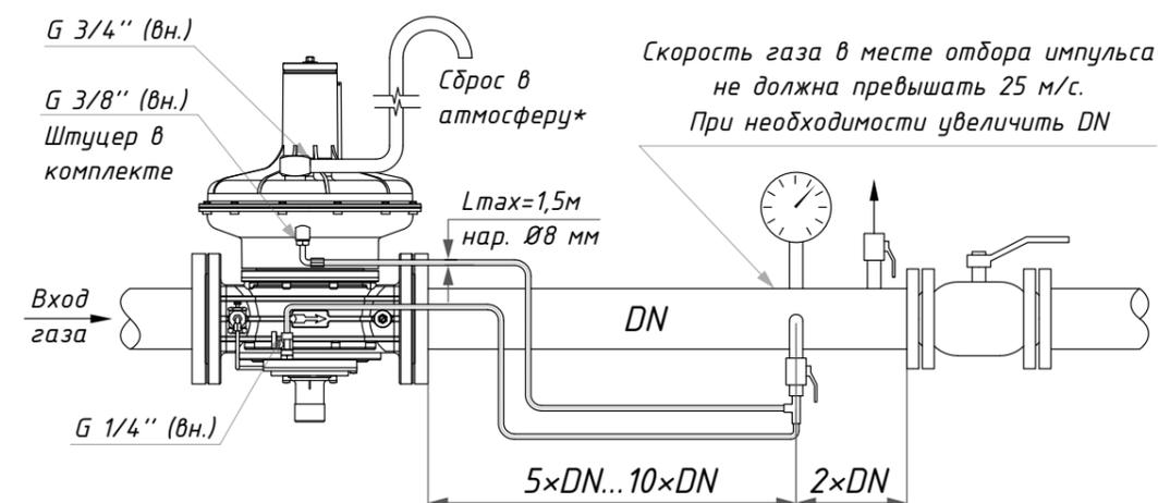
**RG/2MB DN65-DN100 (с расширением)**
