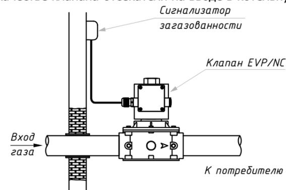
2. Перед счетчиком газа, для предотвращения возникновения пневмодара
